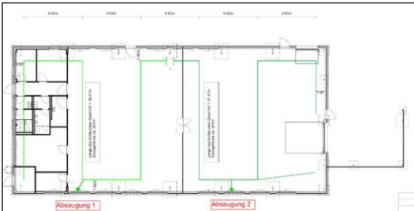
Abbildung 13: Grundriss Tirschenreuth mit Eintrag der Dränagerohre sowie der vorbereiteten Absaugpunkte (Quelle List Bau, München)
