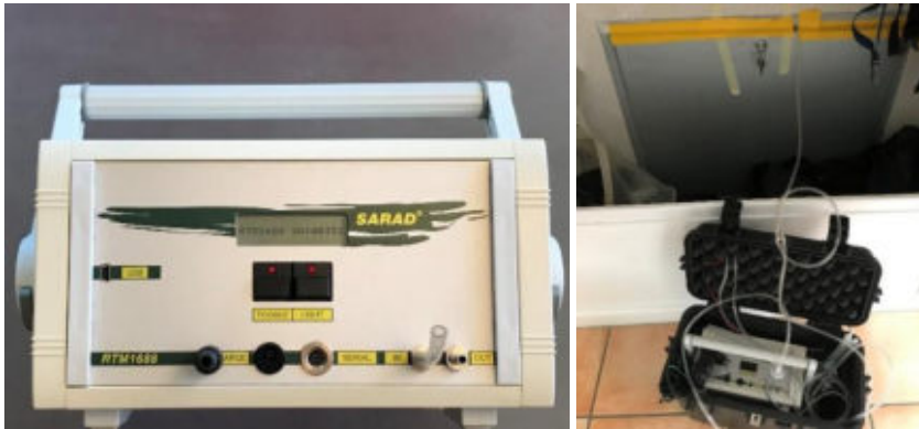
Abbildung 1: links: Radon/Thoron-Messgerät (SARAD), rechts: Radon-Sniffing Messungen im Verteilerkasten der Fußbodenheizung (Bildquelle: Pamela Jentner)
